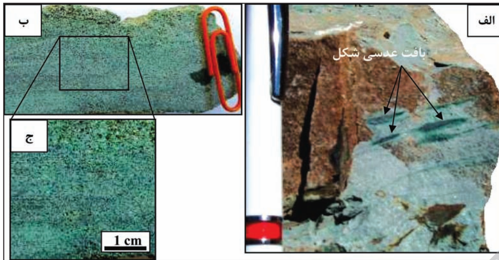
شکل ۱۰- الف) بافت عدسی شکل در کانسار مس چهارآباد. کانی تیره موجود در عدسی‌ها کالکوسیت است؛ ب) بافت دانه‌پراکنده کانی‌های سولفیدی از جمله کالکوسیت در سنگ میزبان ماسه‌سنگی در پهنه شسته شده؛ ج) نمای نزدیکی از شکل ب. بخش‌های تیره رنگ که به صورت دانه‌پراکنده و لامینه‌مانند دیده می‌شوند، بخش‌های دارای کالکوسیت هستند. زمینه سبزرنگ نشانگر تشکیل مالاکیت در زمینه سنگ میزبان است.
