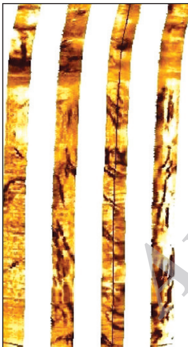
شکل ۳- مقطعی از نمودار تصویری الکتربیکی FMS مربوط به چاه مورد استفاده (مقیاس تصویر ۱/۱۵).
