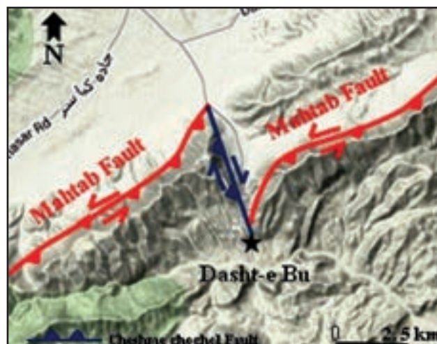
شکل ۱۴- جا به جایی ۴۷۰۰ متری راندگی مهتاب توسط گسل پارگی چشمه قلقل.
