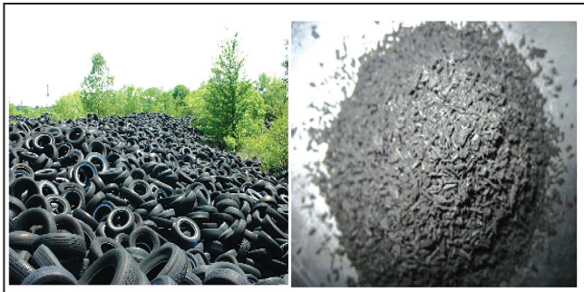
شکل ۲- لاستیک فرسوده و فیبر به دست آمده از آنها.
