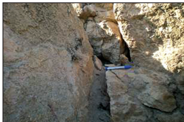
شکل ۶- پرشدگی درزه توسط رس و سیلت.
