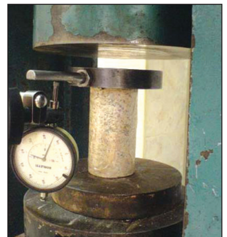
شکل ۱۱- انجام آزمایش مقاومت تک‌محوری سنگ مادر.
