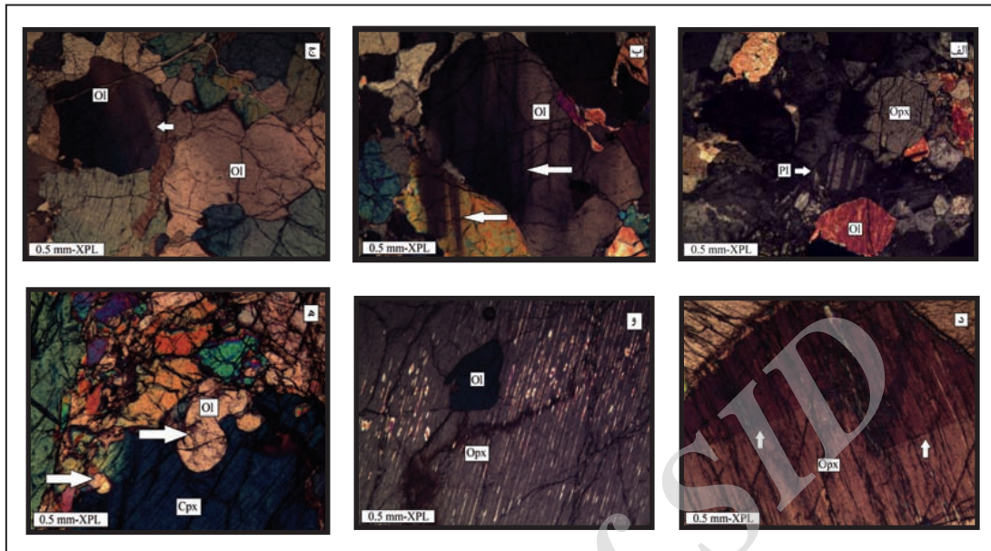
شکل ۳- شواهد میکروسکوپی سازوکار نوردپذیر درون بلوری در مجموعه ده‌شیخ، پیکان‌های سفید ریزساختارهای مورد نظر را نشان می‌دهند. الف) الیون (Ol)، ارتوپروکسن (Opx) و پلاژیوکلاز (Pl) با ماکل رشدی پلی‌سنتتیک در گابرو؛ ب) ماکل دگرشکلی پورفیروکلاست الیون در لرزولیت؛ ج) خاموشی موجی الیون در لرزولیت؛ د) نوار شکنجی ارتوپروکسن در ارتوپروکسن؛ و) تیغه جدایشی کلینوپروکسن در ارتوپروکسن با دربرداری الیون در لرزولیت؛ ه) مهاجرت مرز دانه الیون به کلینوپروکسن (Cpx) در هارزبورژیت.
