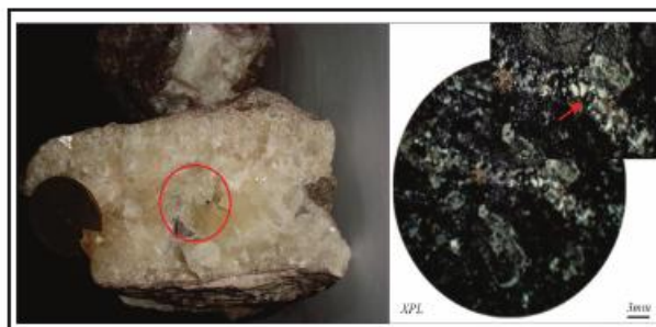
شکل ۲۱- (A) همراهی کانه های مس دار با کانی باطله کلسیت؛ (B) نمای از (A) همراهی کانه های مس دار با کانی باطله کلسیت؛ (A) میانبارهای سیال ثانویه با نشانه S۲؛ (B) میانبارهای سیال اولیه با نشانه P.
