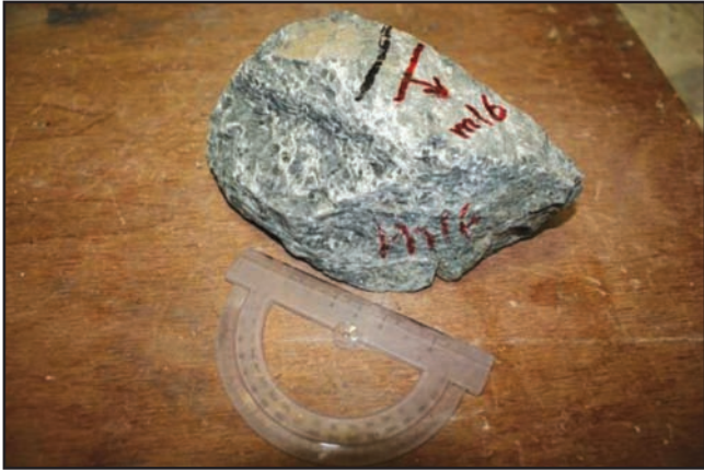
شکل ۱۱- نمونه گابروی میلوئیتی درشت‌بلور با برگوارگی ضعیف (نمونه M16، X: 44^{\circ} 51' 18.08'' , Y: 37^{\circ} 56' 2.36'' )
