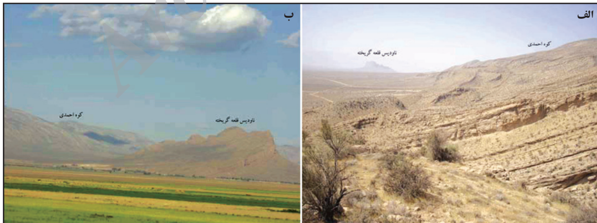
شکل ۱۳- الف) در سمت راست یال جنوبی تاقدیس احمدی از محل پیچیدگی پلانژ خاوری و در سمت چپ و در انتهای دشت سروستان ناودیس فراجسته (Pershed) قلعه گریخته نمایان است؛ دید به سوی شمال باختر؛ ب) در سمت راست شکل ب قرار گرفتن یال‌های ناودیس به سوی بالا به‌طور کامل آشکار است. در هسته این بخش کنگلومرای بختیاری پروتزد دارد، دید به سوی شمال خاوری.
