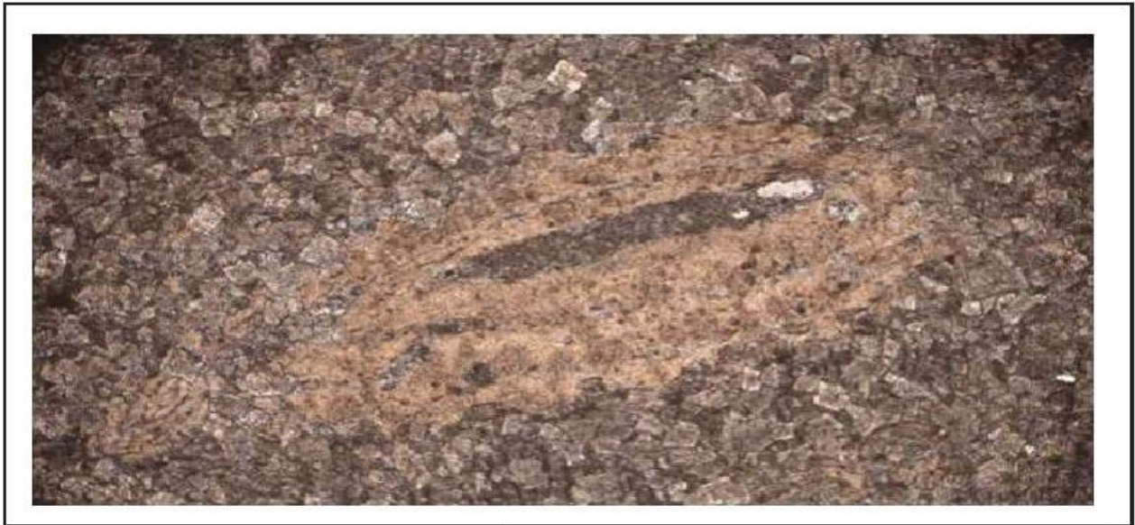
شکل ۷- بلورهای دولومیت پیرامون صدف نومولیت، نمونه ۱۶۲، سازند شهبازان در برش تاقدیس لنگر.
