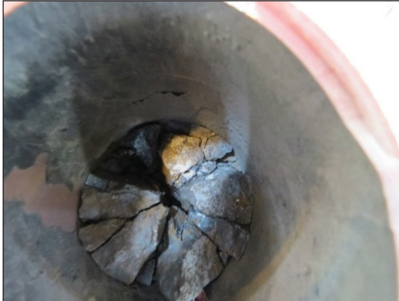
شکل ۱۴- تعداد ترک‌های ایجاد شده در نمونه با درصد مگنتیت ۴۲ درصد.
