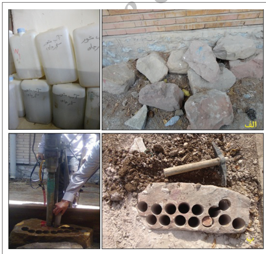
شکل ۱- الف) نمونه‌های اولیه ماسه سنگی و آب شور و نیمه‌شور؛ ب) مغزه‌گیری نمونه‌های ماسه‌سنگی مورد مطالعه.
