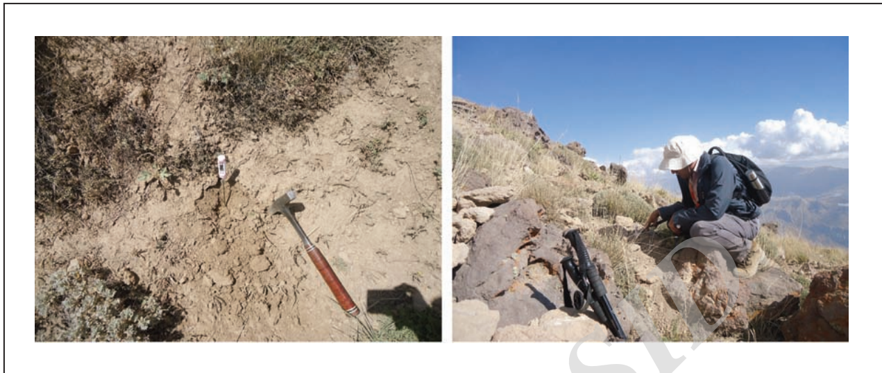
شکل ۶- تصاویری از اندازه‌گیری مستقیم دمای سطح خاک (تا عمق حدود ۲۰ سانتی‌متر).
