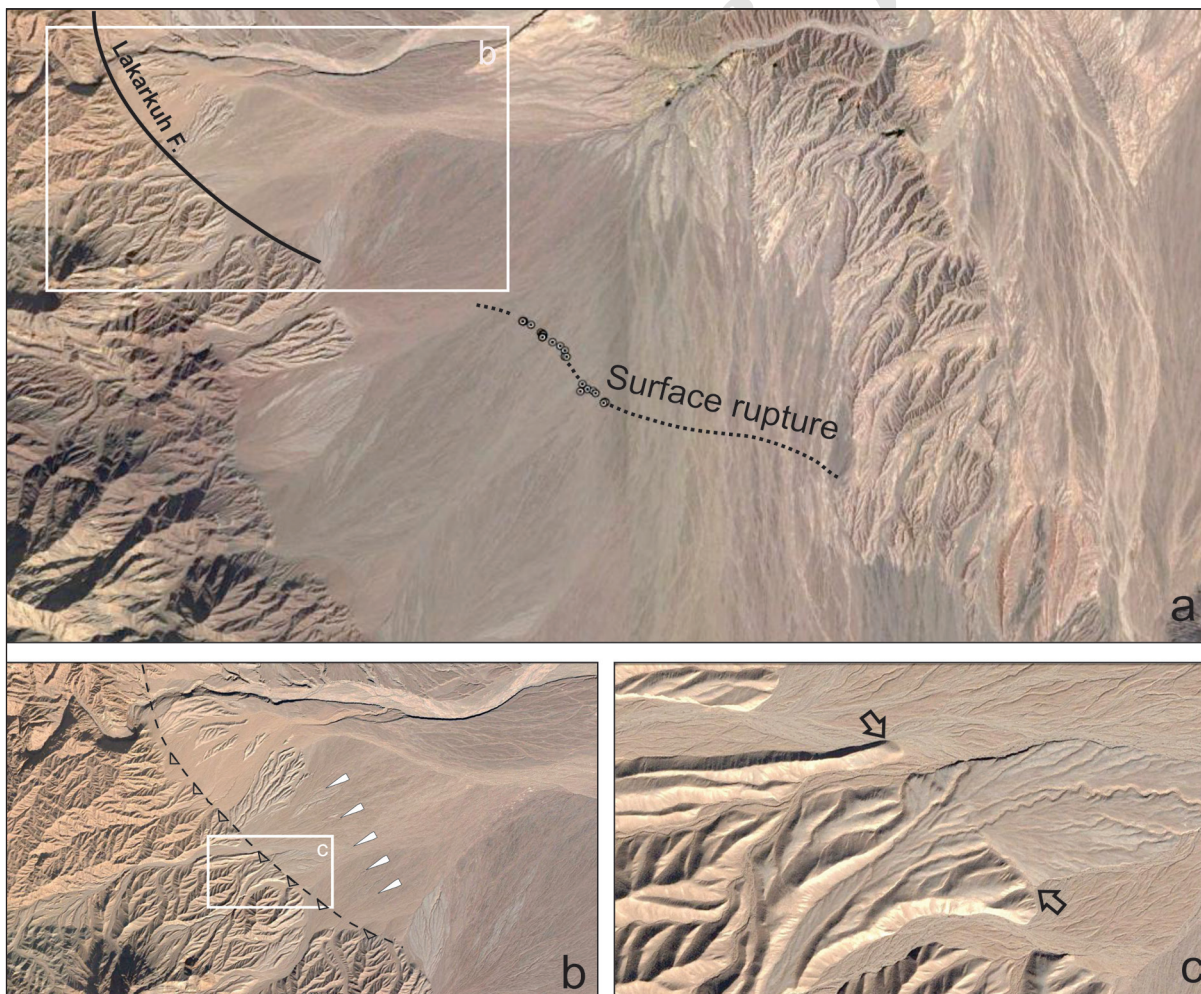
شکل ۳- تصویر ماهواره Copernicus (Google earth)؛ (a) گسلش سطحی همراه با زمین‌لرزه در راستای انشعابات پایانی گسله لکر کوه قرار می‌گیرد. دایره سیاه رنگ محل‌های بازدید میدانی را نشان می‌دهد؛ (b) نمای نزدیک‌تر از راندگی پایانه گسل لکر کوه. فلش‌های سفید رنگ محل گسلش سطحی احتمالی پیش از رویداد زمین‌لرزه اخیر را نشان می‌دهد؛ (c) بریدگی آبرفت‌های کواترن به وسیله راندگی پایانه گسل لکر کوه. برخاستگی بلوک جنوب باختری با شیب به سوی جنوب باختر راندگی همخوانی دارد.
