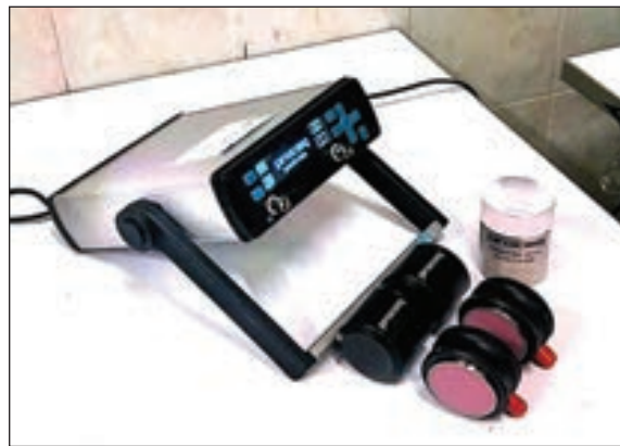
شکل ۵- نمایی از دستگاه اندازه‌گیری سرعت موج در آزمایشگاه.
