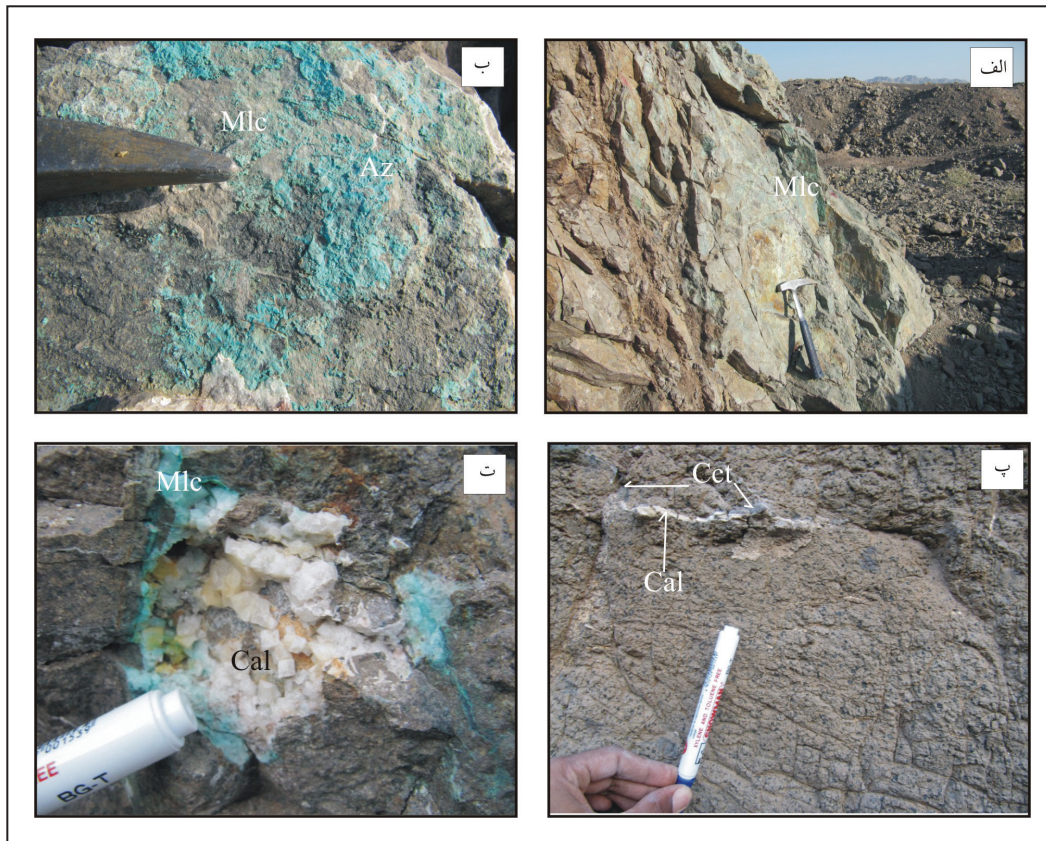
شکل ۶- تصاویر صحرایی از کانی سازی مس شریف آباد، الف) رگچه های مالاکتی در سطوح شکستگی سنگ میزبان پیروکسن آندزیت، ب) تشکیل مالاکتیت و آزوریت در سطح شکستگی واحد ماسه سنگی، پ) رگچه کالکوسیت-کلسیت در سنگ میزبان پیروکسن- آندزیت، ت) حفره پر شده با مالاکتیت و کلسیت در سنگ میزبان پیروکسن آندزیت، حروف اختصاری نشانگر کانیها، از (Whitney and Evans, 2010). (کلسیت: Cal، آزوریت: Az، مالاکتیت: Mlc، کالکوسیت: Cet).
