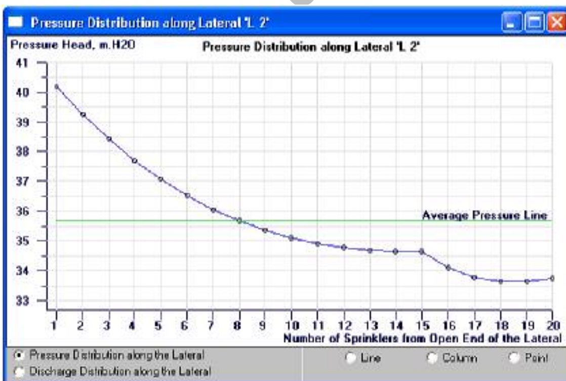
شکل ۴. نمودار مقادیر فشار آبیاش‌های لوله فرعی با آبیاش‌های ثابت با شیب ۱- درصد و با دو قطر مختلف
