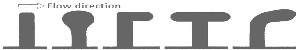
شکل ۱. تقسیم‌بندی آبشکن‌ها از نظر شکل هندسی (سازمان مدیریت و برنامه‌ریزی، ۲۰۰۲)
