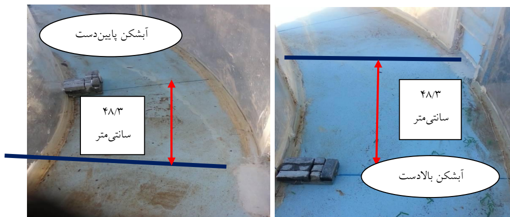
شکل ۵. فاصله آبشکن به اندازه عرض رودخانه از دهانه آبگیر در بالادست و پایین دست
