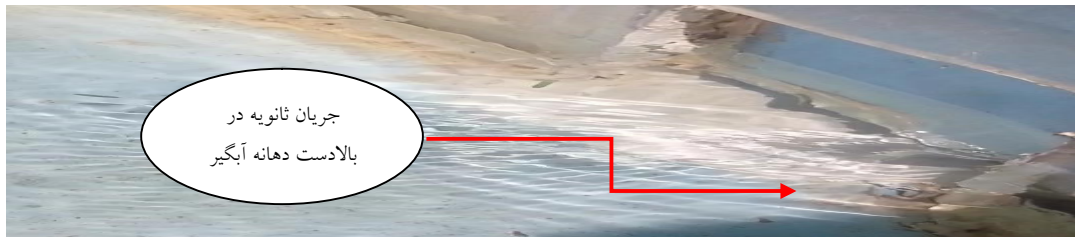
شکل ۱۶. جریان ثانویه در بالادست آبگیر جانبی
