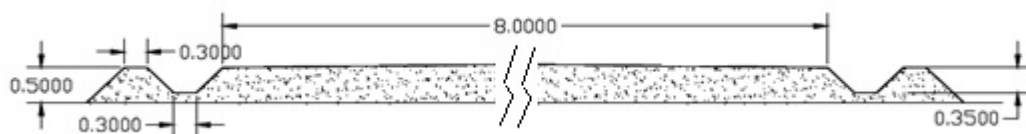
شکل ۲. مقطع تیپ جاده دسترسی و کانال آبیاری کرت‌های شالیزاری در دو طرف آن (۱۳)
