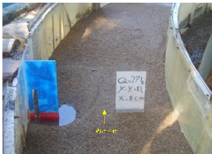
شکل ۳. آبشکن شکافدار و آبشستگی در اطراف آن بعد از آزمایش
