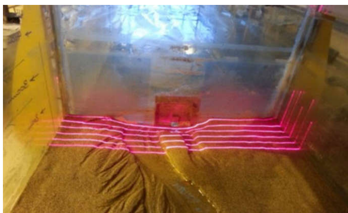
شکل ۲. نمایی از لحظه تشکیل حفره رسوب‌شویی در رسوب‌شویی تحت فشار (مدل فیزیکی)
