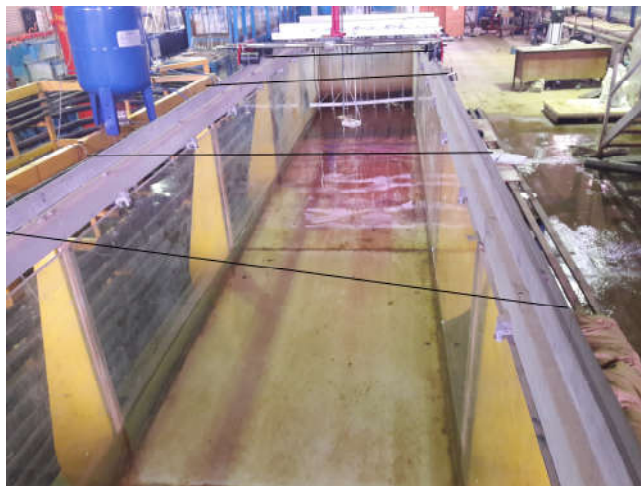
شکل ۱. (رنگی در نسخه الکترونیکی) نمایی از فلوم ۸۰ سانتی متری در حضور سنسورهای اندازه‌گیری غلظت و چهار مقطع اندازه‌گیری
