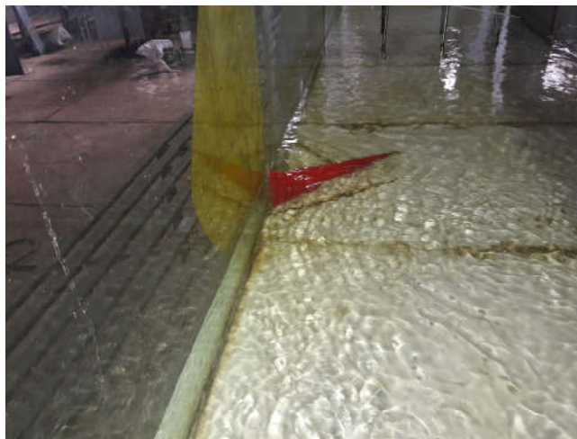
شکل ۲. صفحه مثلثی با زاویه ۴۵ درجه نسبت به جهت اصلی جریان
