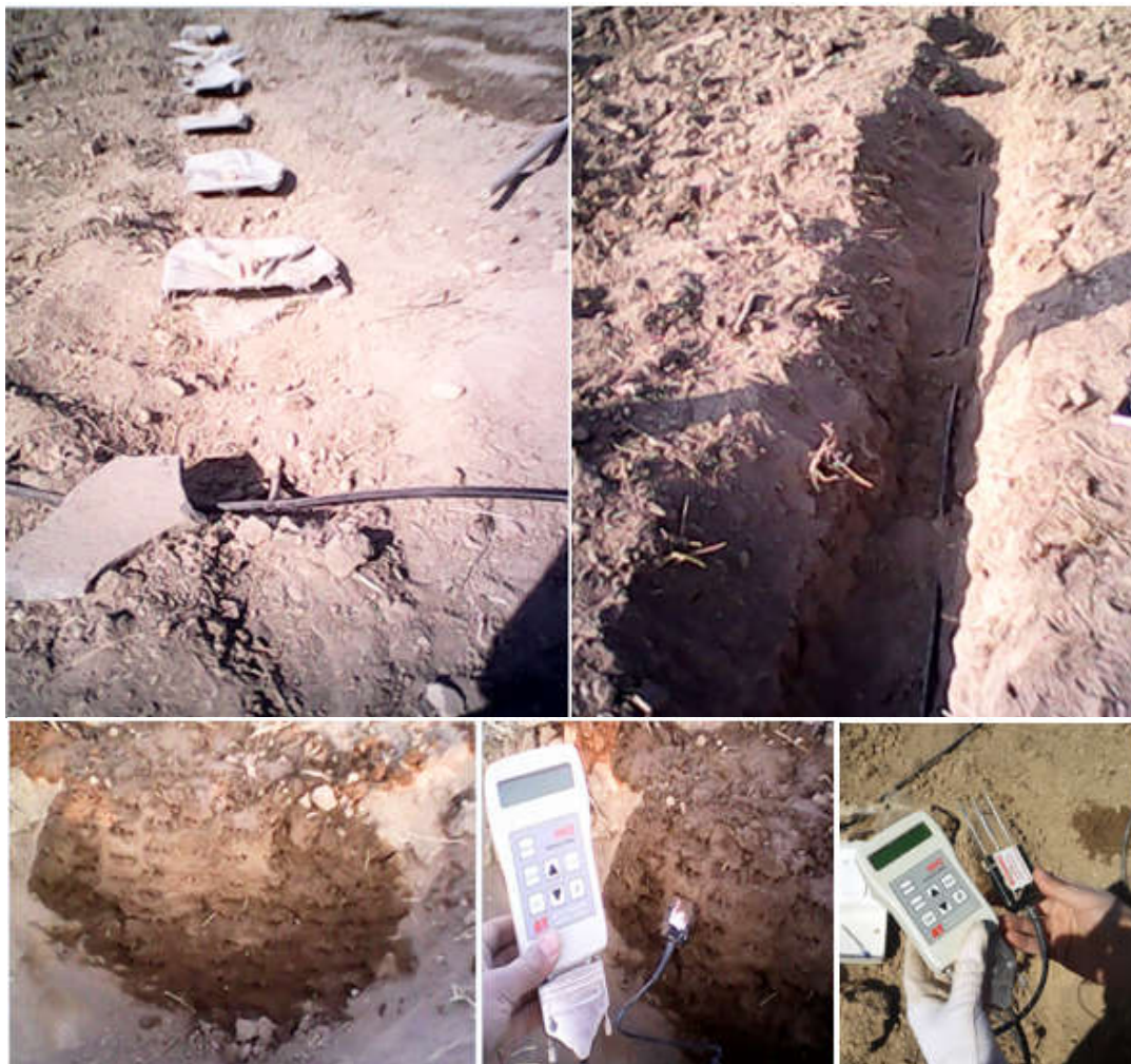
شکل ۱. پروبیل رطوبتی خاک برای آبیاری قطره‌ای زیرسطحی، محل قطره‌چکان‌ها و دستگاه رطوبت‌سنج Wet
