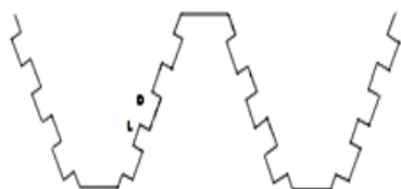
شکل ۳. شکل شماتیک سرریز کنگره‌ای دوزنقه‌ای مرکب دایره‌ای WLCR
