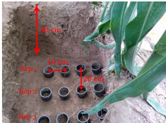
شکل ۱. نمونه برداری از خاکرخ برای اندازه گیری رطوبت خاک
