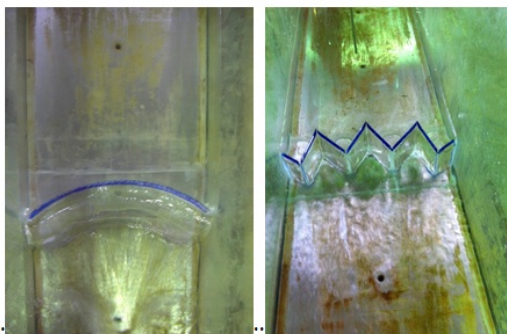
شکل ۲. مدل‌های سرریزها قوسی زیگزاگی و قوسی خطی و جانمایی آنها در فلوم آزمایشگاهی
