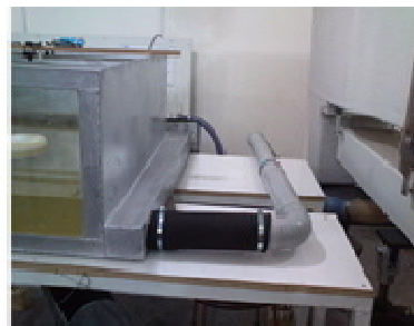
شکل ۳. محل آب‌گیری از فلوم اصلی آزمایشگاه هیدرولیک برای مدل فیزیکی سرریز نیلوفری
