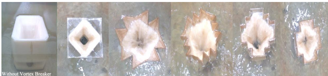
شکل ۵. حالت بدون زیگزاگ و پنج حالت قرارگیری زیگزاگ برای سرریز نیلوفری مربعی
