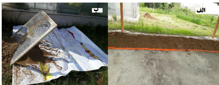
شکل ۱. مراحل آماده سازی خاک برای انجام پژوهش حاضر: الف) خشک کردن خاک در هوای آزاد و ب) الک کردن
