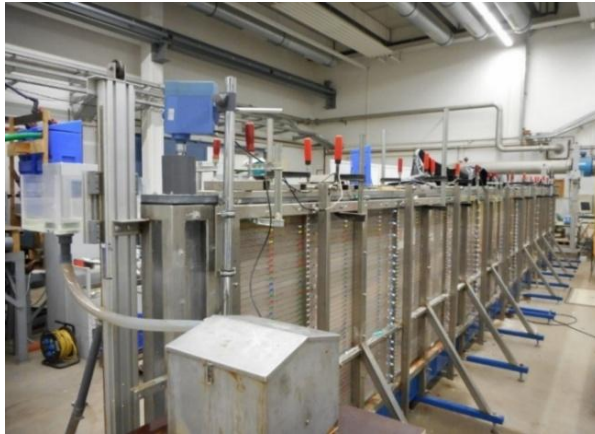
شکل ۱. مدل تانک با ابعاد z=1/225 m و x=10 m و y=0/1 m در آزمایشگاه هیدرولیک دانشگاه کاسل آلمان
