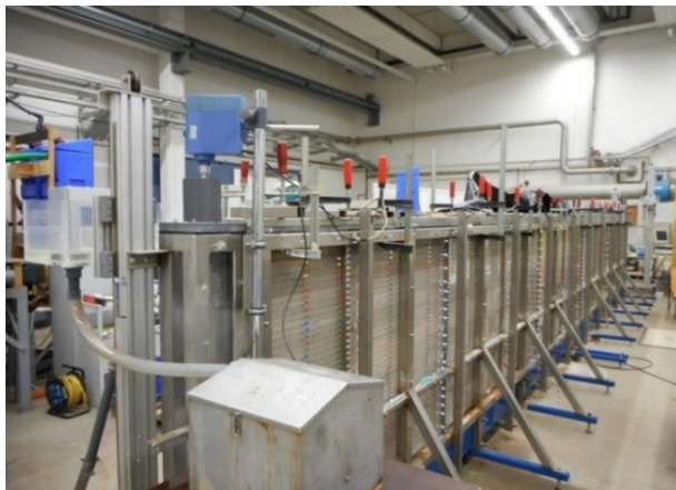
شکل ۱. مدل تانک با ابعاد y = 0.1 \text{ m} و x = 9/8 \text{ m} , z = 1/225 \text{ m} در آزمایشگاه هیدرولیک دانشگاه کاسل آلمان
