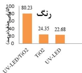
تصویر ۳: کارایی فرآیندهای UV-LED، TiO_2 و UV-LED/ TiO_2 در حذف رنگ و کاهش COD تحت شرایط بهینه (غلظت TiO_2 برابر با ۱ g/L و pH = 3 و زمان ۱۲۰ دقیقه)
