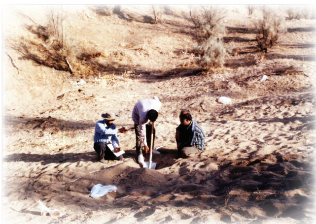
شکل شماره ۲: قراردادن نمونه چوبها در عمق ۳۰ سانتیمتری زیر شن (شکل از نگارنده)
