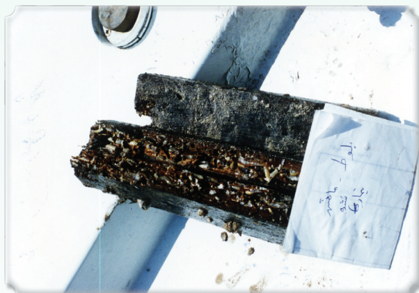
شکل ۶- تخریب نمونه های آزمونی شاهد بلوط به وسیله تردوها پس از ۱۰ ماه-ماهشهر
