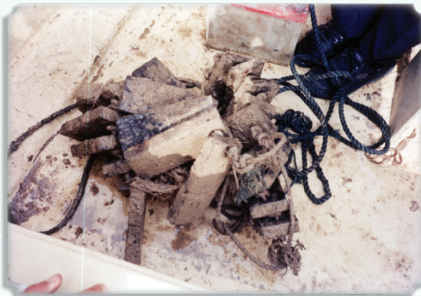
شکل ۴- ارزیابی نمونه های آزمونى پس از ۶ ماه استقرار در دریا
