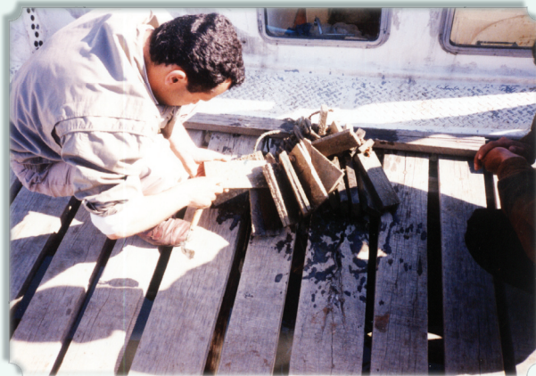
شکل ۳- ارزیابی نمونه های آزمونى شاهد پس از ۱۲ ماه استقرار در دریا ( آشوراده - بندر ترکمن )
