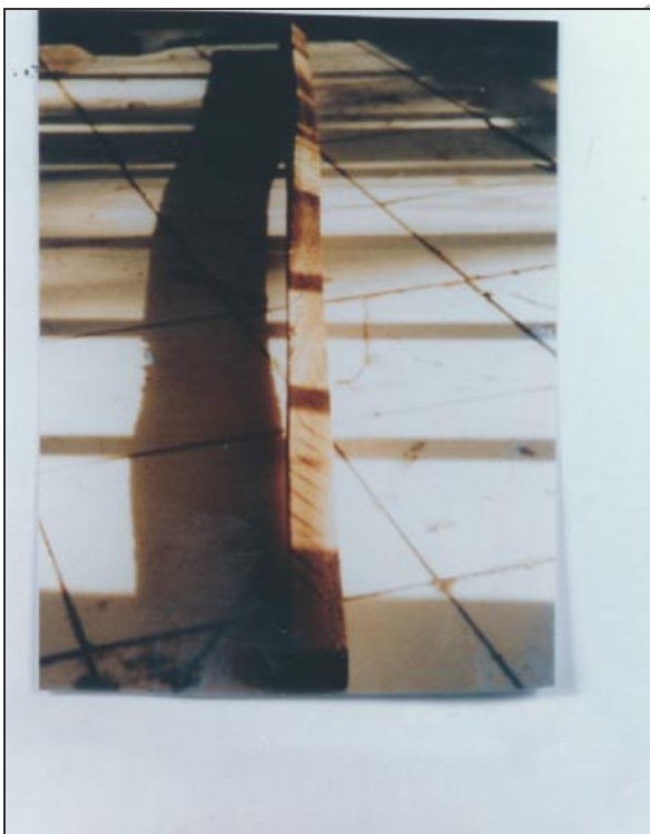
تصویر ۲- معایب چوب خشک‌کنی چوب‌کالیپتوس کاملدونسیس (کمانی شدن و تاب خوردگی ...)
