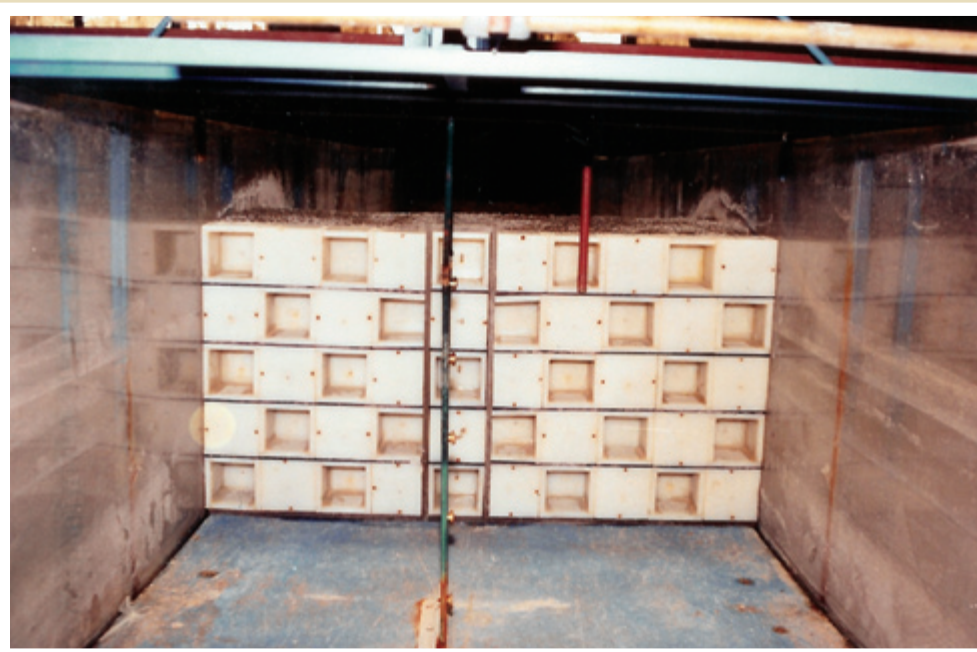
شکل ۱- یکی از مدل‌های ساخته شده در داخل فلوم (دیوار نیمه متخلخل یا شطرنجی)
