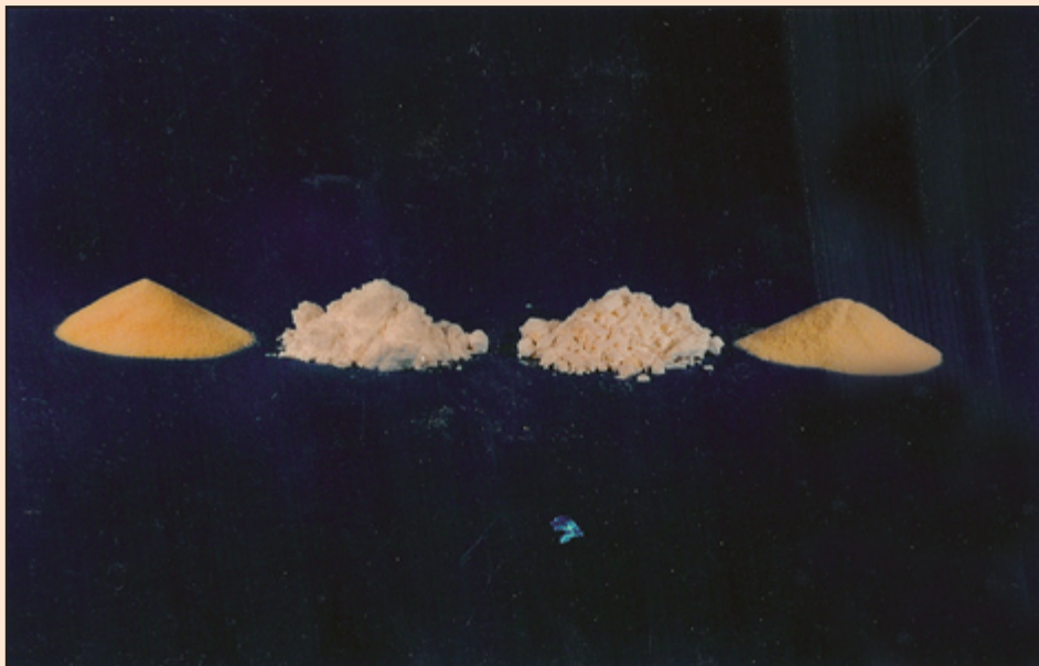
شکل ۲- مقایسه آگار، نشاسته گندم و نشاسته ذرت از نظر شکل ظاهری
