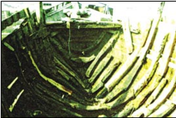
شکل ۲- چوبهای دنده‌های اصلی لنج که بهترین کاربرد آنهاست خمیدگی‌های موجود در تنه چوب کهور ایرانی در این قسمت از ساخت لنج‌هاست
