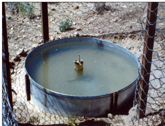
عکس ۲- تشتک تبخیر نصب در محل سد خاکی دره مرید
