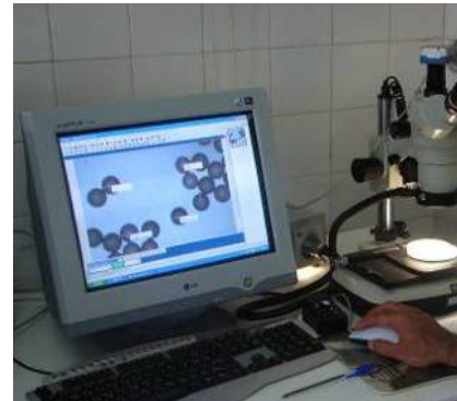
شکل ۲- اندازه گیری قطر سیستمها با دستگاه Motic 2000
