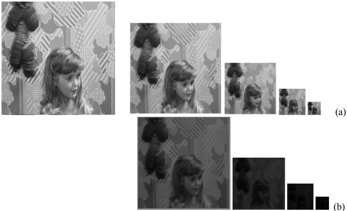
شکل ۳ تصاویر نمونه برداری شده لایه های مختلف هرم: بالا سمت چپ تصویر اصلی و ردیف های بالا راست و پایین، به ترتیب، ۴ لایه اول هرم هژمان-توت و هرم ارائه شده
