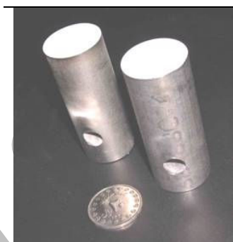
شکل ۲ مجموعه مورد نیاز برای آزمون استحکام چسبندگی بر اساس استاندارد ایزو به همراه نمونه‌های ساخته شده (۱): میله آلایژ تیتانیومی به قطر 2/54 \text{ cm} ، ۲: بین (جهت اتصال میله تیتانیومی به یوک و اتصال یوک به دستگاه آزمون)، ۳: یوک، ۴: چسب، ۵: پوشش)
