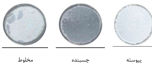
شکل ۴ الگوی شکست نمونه‌ها
