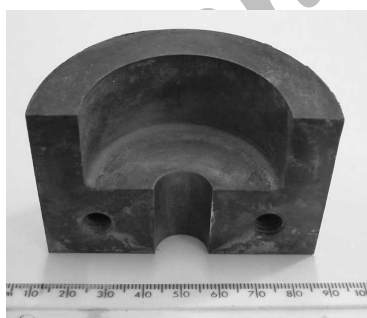
شکل ۳ نمای یک لنگه از قالب اکستروژن گرم و سوراخ کف آن برای برآورد نسبت تغییر شکل خمیر کامپوزیت (75/12). برای وضوح بالاتر و تشخیص کیفیت فصل مشترک AA6061/SiCp، از نمونه‌های میکروسکوپ
