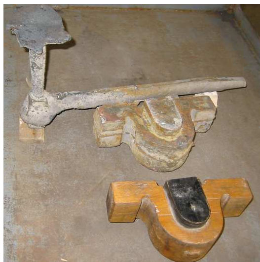
شکل 14 تصاویری از قطعه ریخته شده پس از جدانمودن تغذیه همراه سیستم راهگاهی و مدل چوبی آن.
