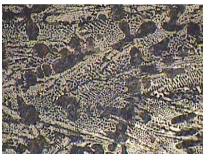
شکل 17 ریزساختار نمونه 3 ( اتصال سیستم راهگاهی) پس از 200 روز بزرگنمایی 200
