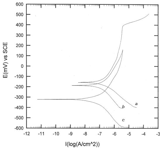
تصویر ۴ - نمودارهای پلاریزاسیون کاتدی و آندی سه نوع زیرلایه فلزی بدون پوشش
