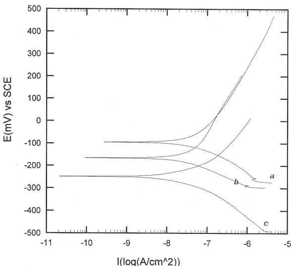
تصویر ۵ - نمودارهای پلاریزاسیون کاتدی و آندی سه نوع زیرلایه فلزی با پوشش هیدروکسی آپاتیت
