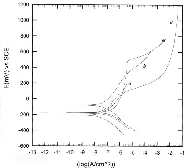
تصویر ۹- نمودارهای پلاریزاسیون کاتدی و آندی فولاد زنگنزن با سه نوع پوشش و تیتانیوم خالص تجاری با پوشش هیدروکسی آپاتیت در محلول رینگر در دمای ۳۷ درجه سانتیگراد
