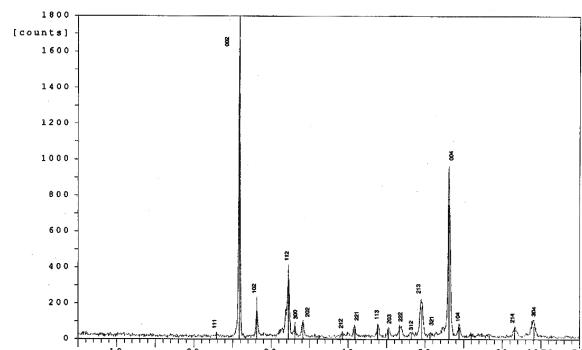
تصویر ۲ - الگوی پراش پرتوایکس پوشش کامپوزیت لایه‌ای هیدروکسی آپاتیت-تیتانیوم بر روی فولاد زنگزن ۳۱۶ ال
