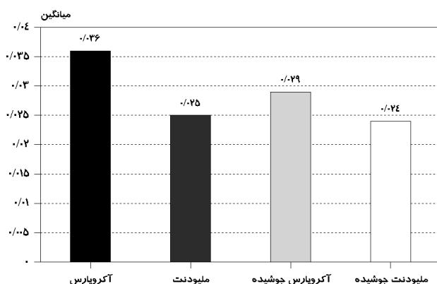
سنجهش تغییرات ابعادی در حد میکرون استفاده گردید. برای هر گروه ۱۰ نمونه و در مجموع ۴۰ نمونه ساخته شد. پلیمر و مونومر آکریل‌های آکروپارس و ملیودنت به نسبت حجمی ۳ به ۱ در دمای اتاق مخلوط شدند و در مرحله خمیری، آکریل درون مولد فلزی با ابعاد ذکر شده، قرار گرفت و صفحه شیشه‌ای روی مولد قرار داده شد و پس از حذف اضافات، تا تکمیل پلیمریزاسیون، تأمل شد و سپس نمونه از مولد خارج گردید.
