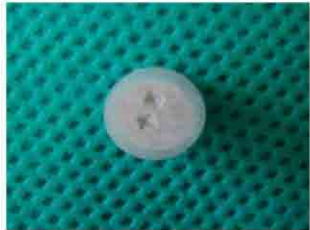
شکل ۴- اثر سنبه فرورونده (Indenter) بر سطح ماده
