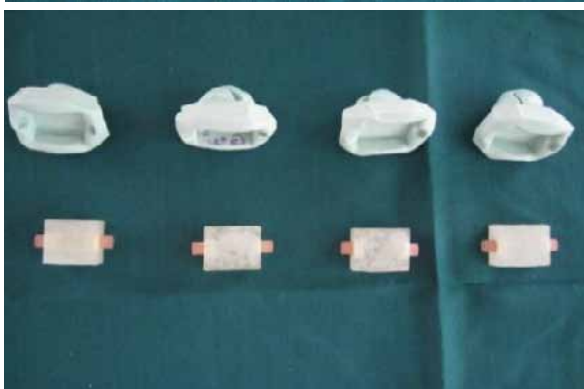
شکل ۵- قرار دادن نمونه‌ها در پوتی
