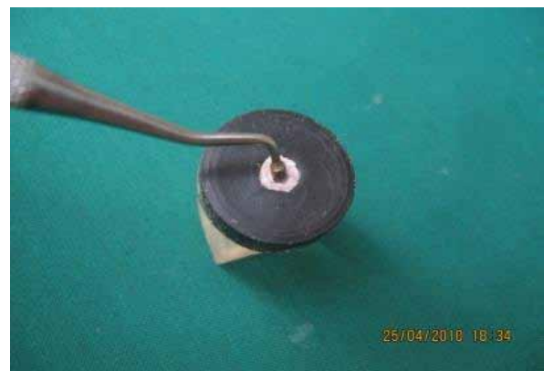
شکل ۳- پک کردن نمونه‌هایی از آکریل بیس خودبه خود پلیمریزه شونده در داخل حفره ۵ میلی‌متری
