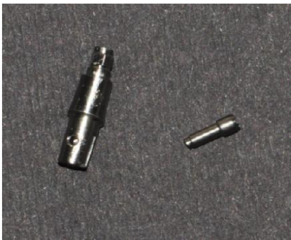
شکل ۴- شکست پیچ اباتمنت در گروه تیتانیومی پیش‌ساخته
