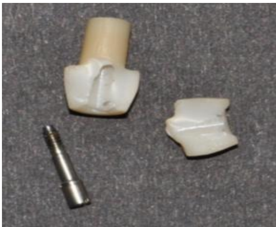
شکل ۳- شکست ناحیه اتصال در گروه Copy-milled
