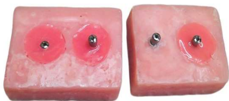
شکل ۲- بلوک‌های آکرلی تهیه شدند به طوری که ایمپلنت‌ها در عمق‌های مختلف آن قرار گرفته‌اند.
