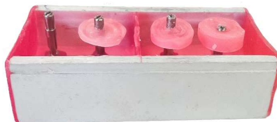
شکل ۱- ایمپلنت‌ها در عمق‌های مختلف قرار داده شده‌اند و توسط موم ثابت شدند.
